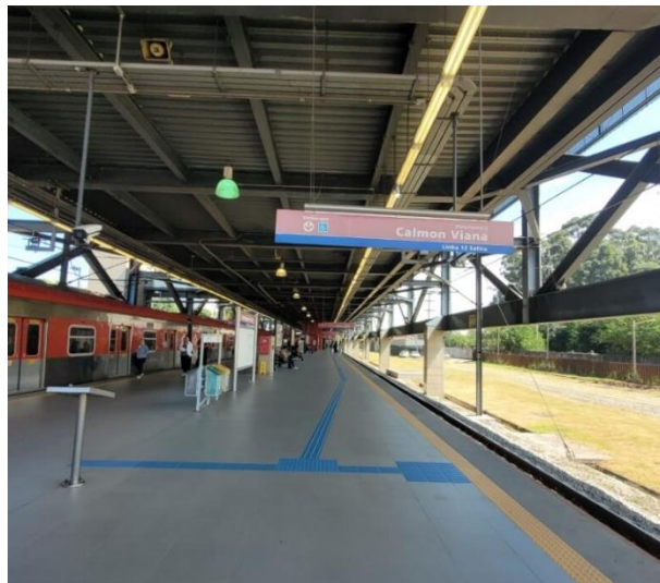
Figura 110 – Rota tátil e sinalização na plataforma
