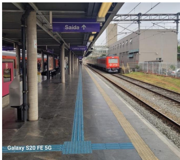
Figura 120 – Rota tátil e sinalização na plataforma
