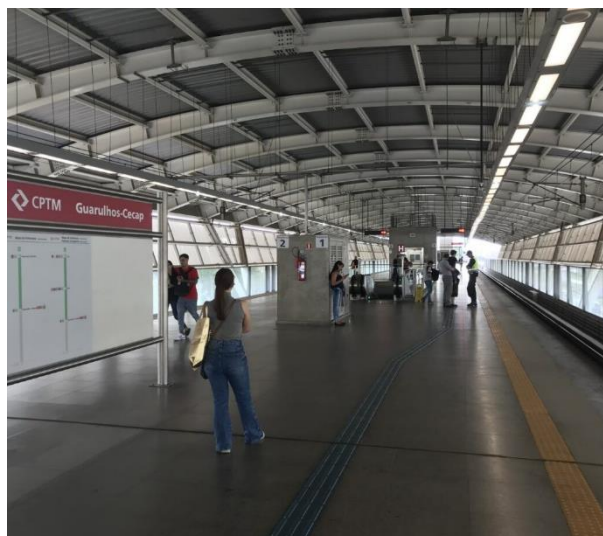
Figura 145 – Rota tátil e sinalização na plataforma
