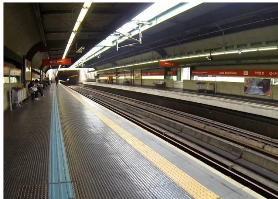
Figura 38 – Rota tátil e sinalização na plataforma
