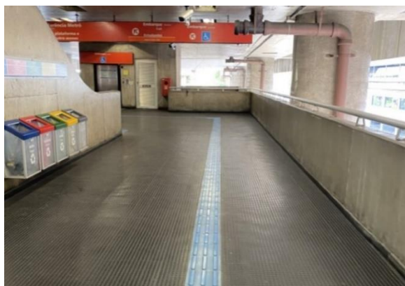
Figura 28 – Rota tátil em direção ao embarque e à transferência para a linha de metrô (3-Vermelha)
