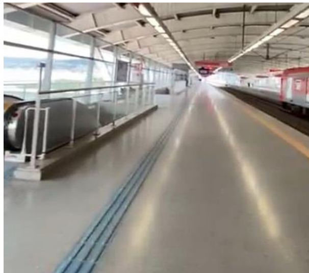
Figura 150 – Rota tátil e sinalização na plataforma
