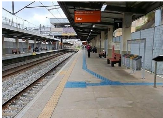
Figura 48 – Rota tátil e sinalização na plataforma
